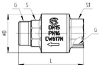
Рисунок 2 – Габаритные размеры клапана.
