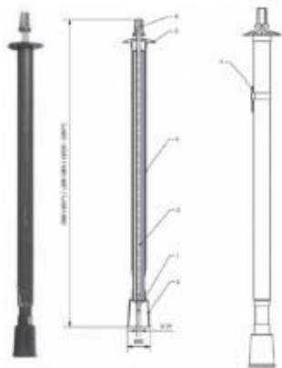
Рис. 3 Телескопический шток для задвижки 30ч39р.
