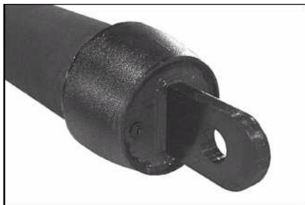
Рисунок 42 Приспособление для протягивания труб.
