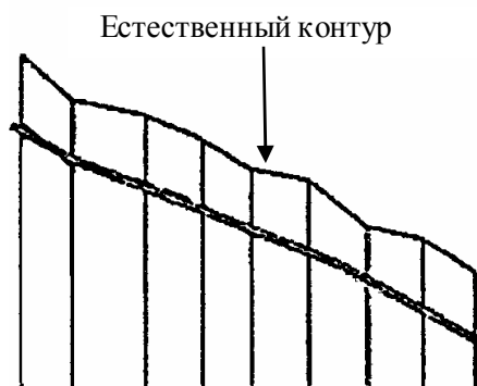
Рисунок 19 Трубопровод с постоянным уклоном.
