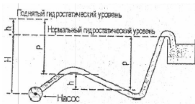
Рисунок 18 Условия в напорном трубопроводе.
