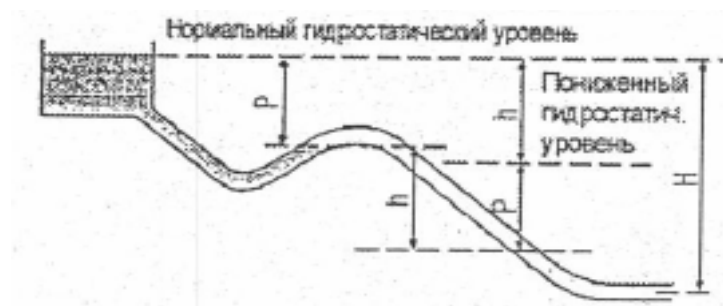
Рисунок 17 Условия в гравитационном трубопроводе.
