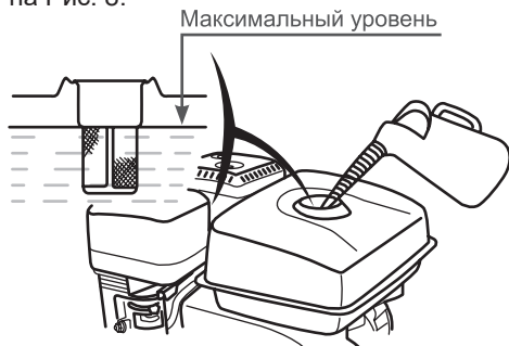
Рис. 8 Максимальный уровень топлива в топливном баке
