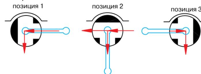
Тип затвора (L,T) обозначен на рукоятке и на торце штока.
