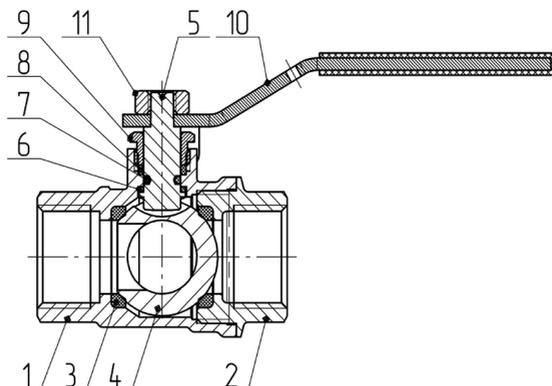
Рисунок 1 – Конструкция шарового крана
