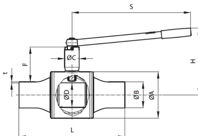
Габаритные и присоединительные размеры кранов шаровых типа JiP Full Bore с патрубками под приварку.
