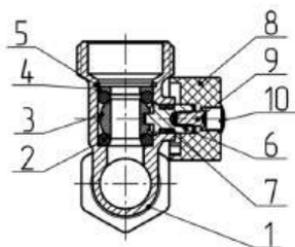
Рисунок 1 – Конструкция крана
