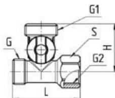
Рисунок 2 – Габаритные размеры крана.
