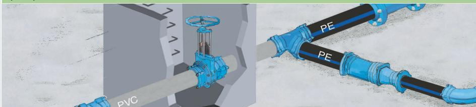
Шиберная задвижка с мягким уплотнением для жидких и сухих сред в промышленном строительстве, например, на очистных сооружениях, в бумажной и сырьевой, горно-добывающей, химической и комбикормовой промышленности.
