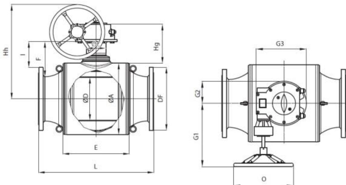
Для передачи крутящего момента на шток крана с целью снижения усилия, прилагаемого для открывания/закрывания предусмотрены модели с редукторным приводом шара, начиная от кранов с номинальным диаметром DN50.
