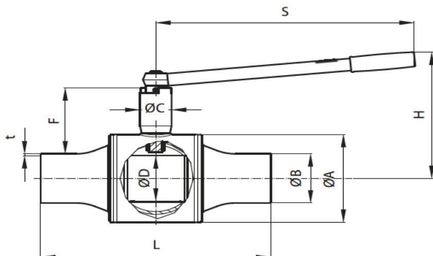
Габаритные и присоединительные размеры кранов шаровых типа JiP Full Borec патрубками под приварку.
