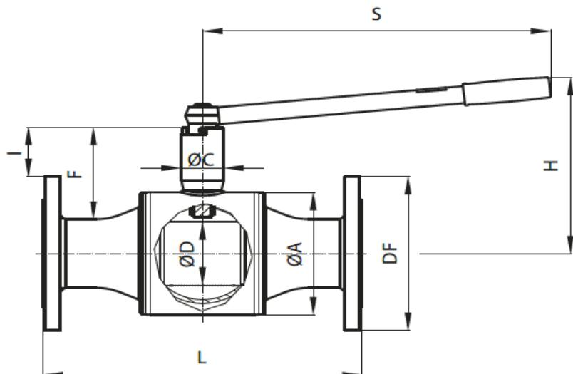
Габаритные и присоединительные размеры кранов шаровых типа JiP Full Bore, фланцевые.
