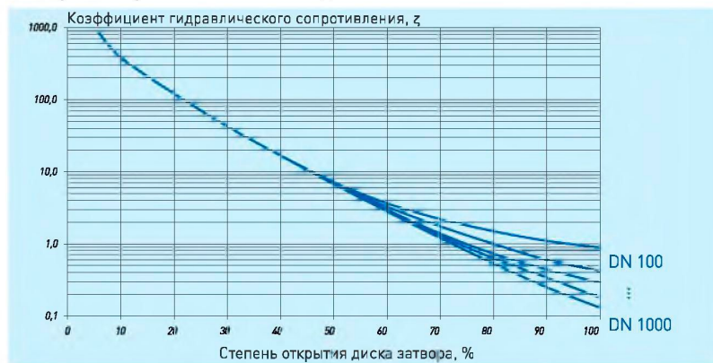
Значения коэффициента гидравлического сопротивления
