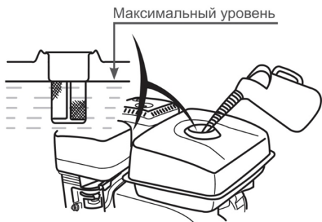
Рис. 8 Максимальный уровень топлива в топливном баке
