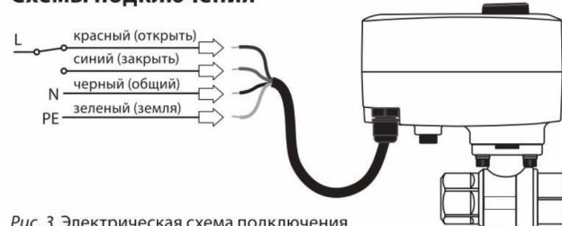
Рис. 3 Электрическая схема подключения крана с электроприводом серии Neptun Bugatti Pro 220B SE
